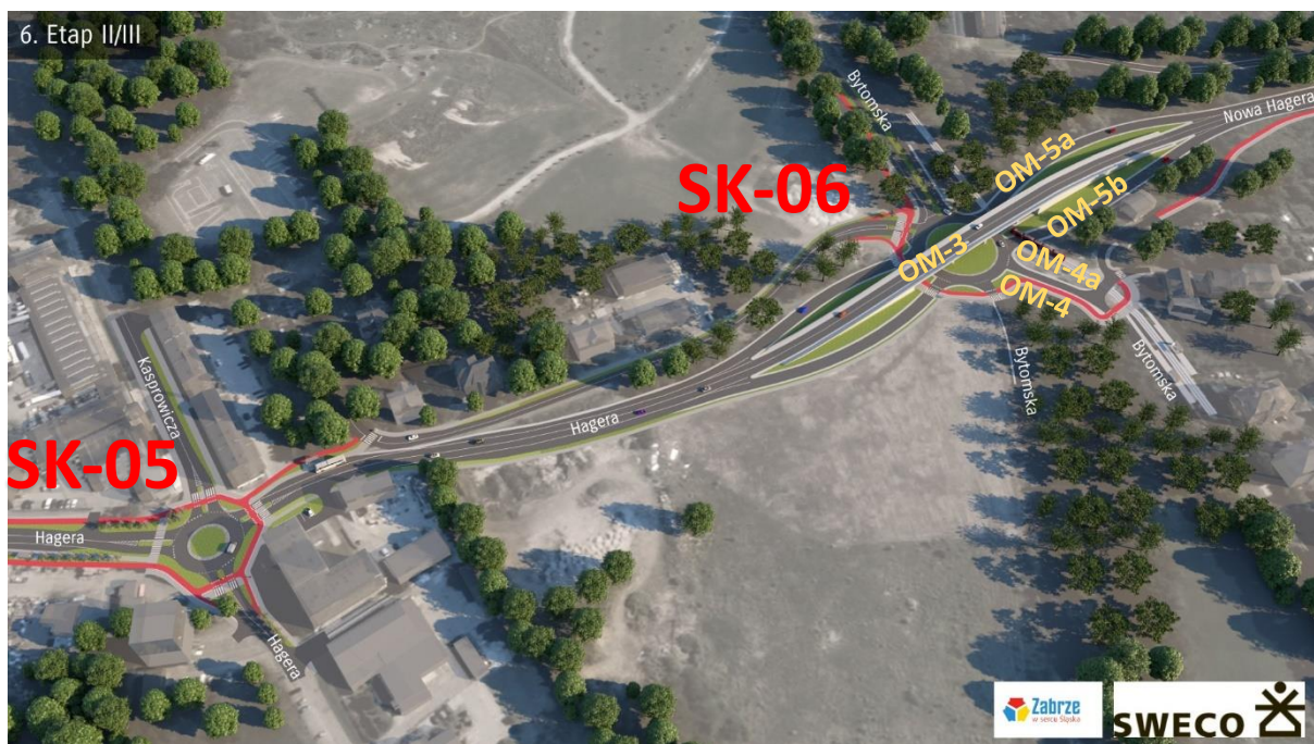
Skrzyżowanie SK-05 (Hagera - Kasprowicza), Skrzyżowanie SK-06 (Hagera - Bytomska), OM-3 – estakada nad rondem, OM-4, OM-4a, OM-5a, OM5b – obiekty mostowe nad rzeką Bytomką
