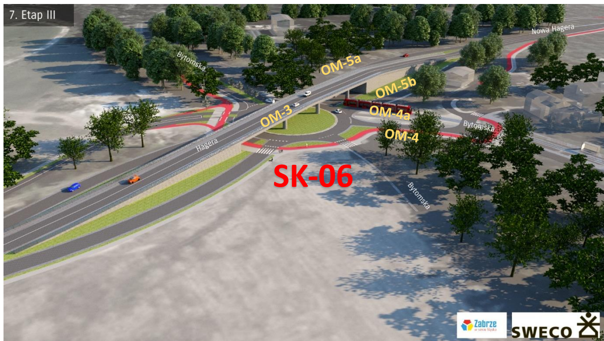
Węzeł SK-06 (Hagera - Bytomska), OM-3 – estakada nad rondem, OM-4, OM-4a, OM-5a, OM5b – obiekty mostowe nad rzeką Bytomką
